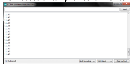
Gambar 3.6 Tampilan Serial Monitor pada Pengujian Baterai Lipo
