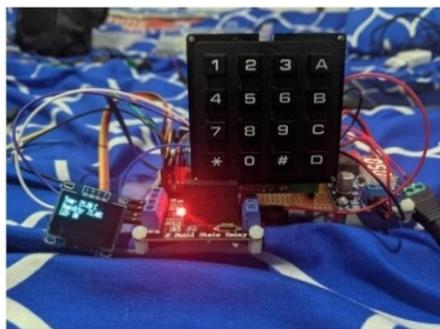
Gambar 11. Pegujian Sistem Sebelum Diintegrasikan dengan Lemari
