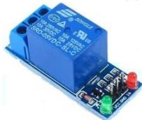
Gambar 6. Rangkaian Driver Relay dan bentuk fisik
