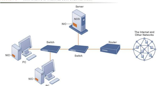
FIGURE 7-1 COMPONENTS OF A SIMPLE COMPUTER NETWORK
